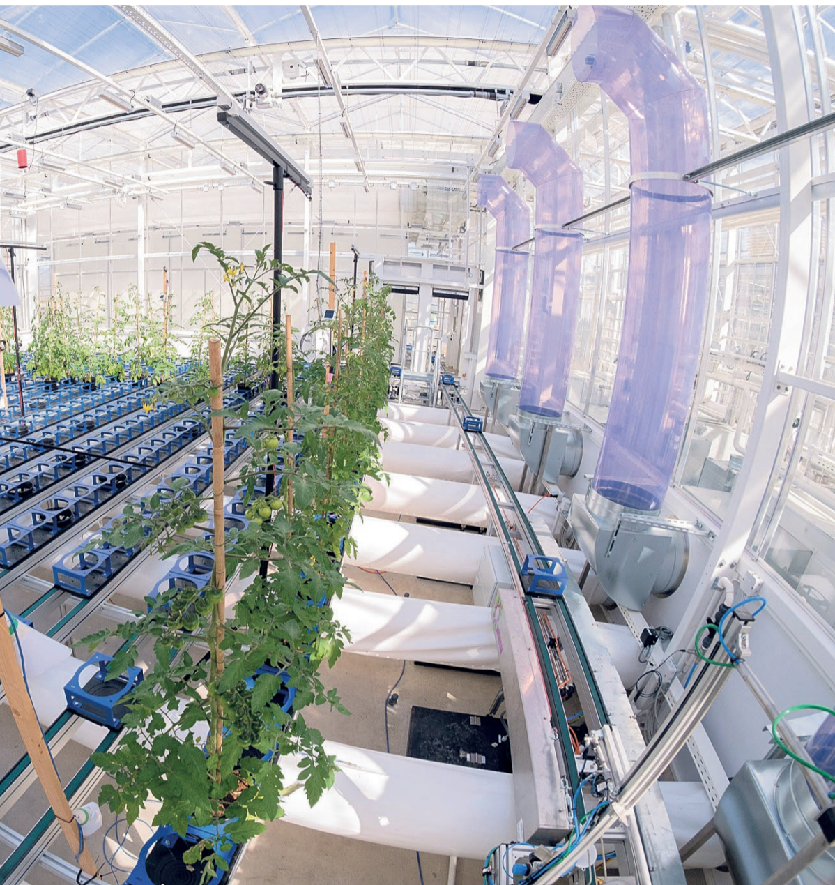
Planten als fotomodellen naar een detectiekast om te worden gefenotyperd.
